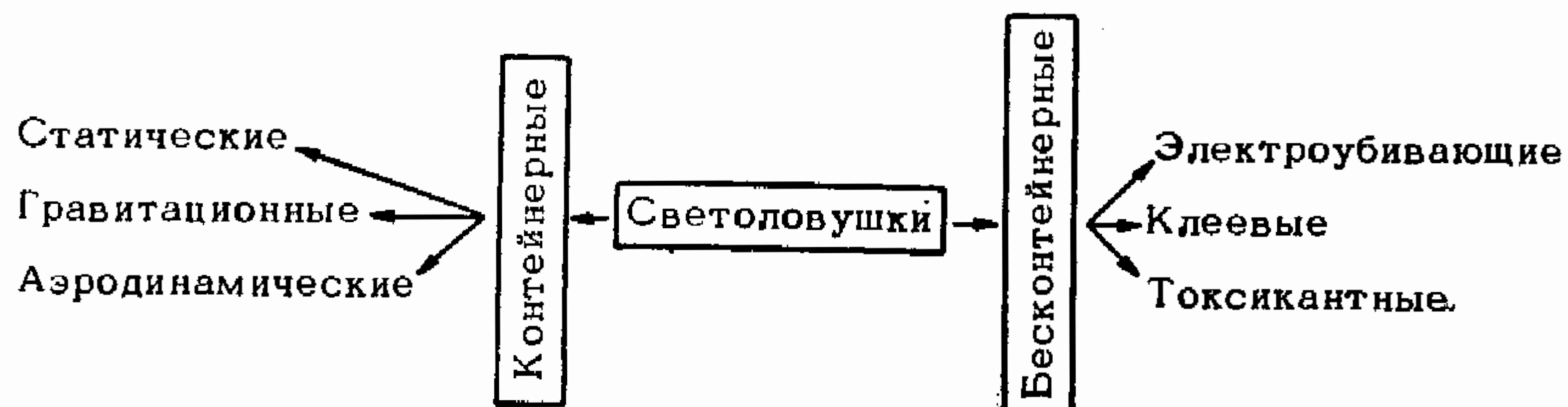
Рис. 3. Типы конструкций светоловушек.
