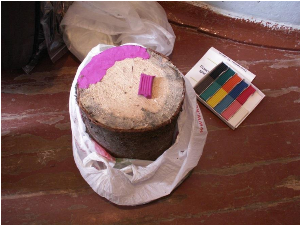
Рисунок 7 — Обработка торцов бревен, заселенных подкорниками.
