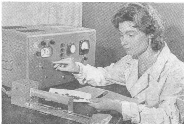
Рис. 4. Отбор маркированных насекомых на лабораторной радиометрической установке Б-2.
