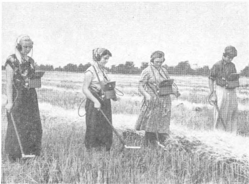
Рис. 3. Поиски маркированных клопов в поле с помощью радиометрической аппаратуры.
